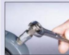
4- Visser ensuite le raccord Quicklinc dans l'adaptateur Zerk-Lock
