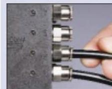
1- Installer le raccord Quicklinc dans le distributeur et insérer le câble.
