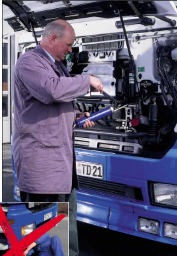
Grâce au système BDS, un véhicule peut être lubrifié sans occuper un pont.
