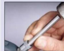
3- A l'aide d'un outil à riveter et d'un marteau, presser l'adaptateur Zerk-Lock
