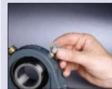
2- Placer un adaptateur Zerk-Lock sur le graisseur
