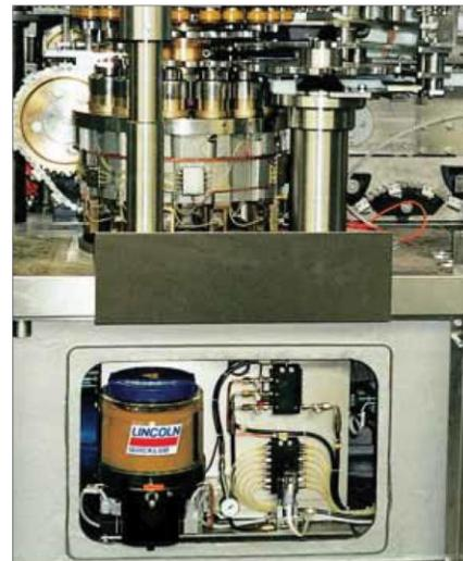
Dispositif de remplissage équipé d'une installation Quicklub
