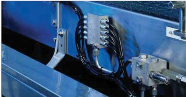
Bande transporteuse avec distributeurs double ligne et distributeur progressif
