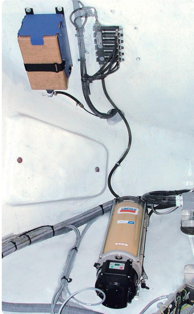
Système de lubrification 603S avec extracteur type SE1, et bac de collecte
