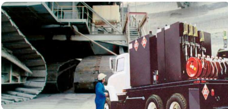
Lubrovan : service de lubrification avec pompes hydrauliques Power-Master III
