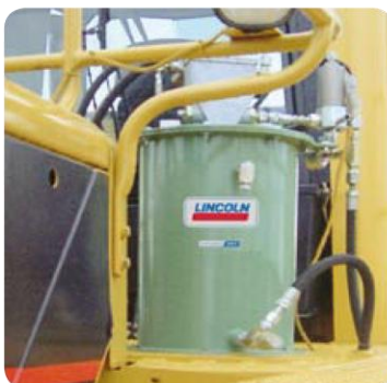
Pompe de lubrification centralisée FlowMaster
