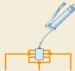
BDS Centralisation et répartition à partir d'un point en graissage manuel
