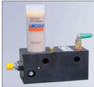
Le détendeur est réglable de manière à ce que la pompe exécute seulement un cycle de lubrification (course) en une minute et qu'elle distribue ainsi  $0,14 \text{ cm}^3$  de lubrifiant (ou  $2,8 \text{ cm}^3$  selon le réglage en usine).
